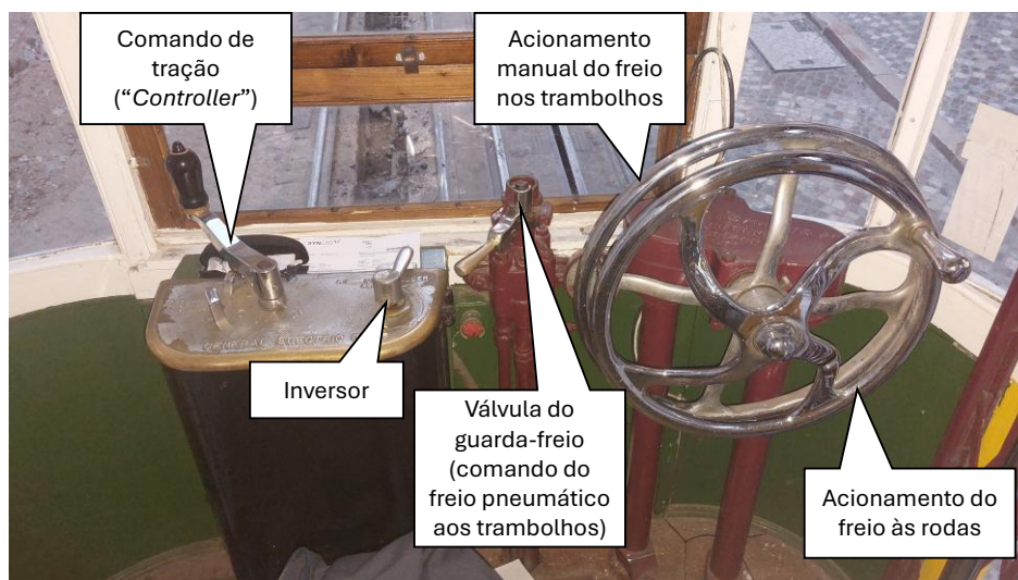
Fig. 6 - Comandos das cabinas.
