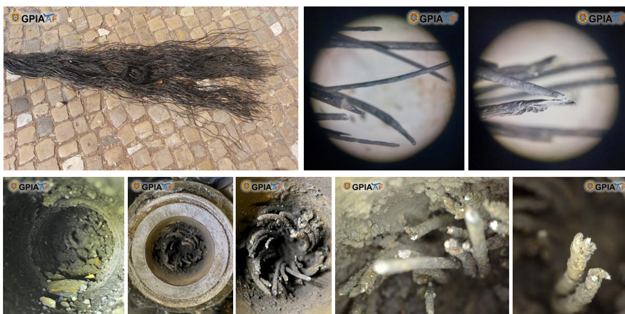
Fig. 12 - Imagens de pormenor das fraturas dos arames.
